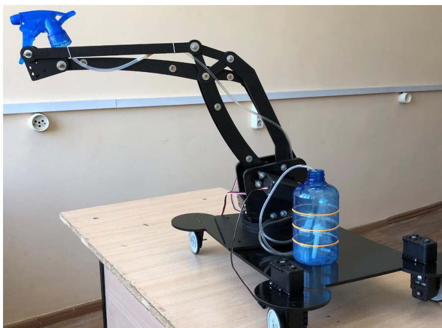
2.12 - сурет-робот-манипуляторға орнатылған өсімдіктерді бүрку жүйесі
