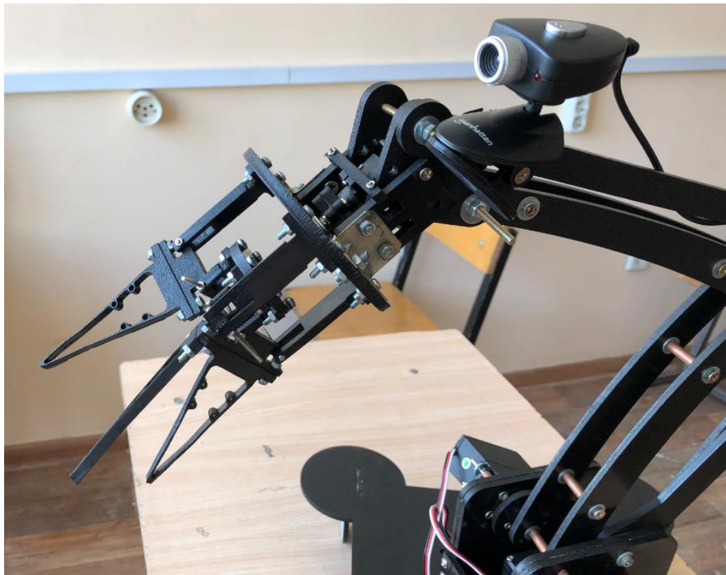
3.2 - сурет-көру жүйесі бар Робот - манипулятор
